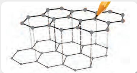
Estructura molecular del grafito, uno de los alótropos del carbono.
