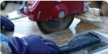
Esta sierra tiene un recubrimiento diamantado.
