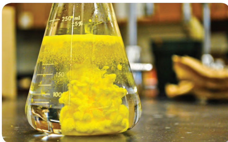
Figura 1.53 La formación del yoduro de plomo es muy evidente, ya que además de formarse un precipitado, hay un marcado cambio de color.
