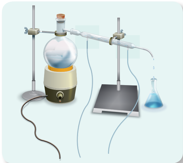
Figura 1.37 Este dispositivo de destilación es usado por los científicos para recuperar el vapor que genera la ebullición de un líquido. El vapor es conducido a través de un tubo condensador.
