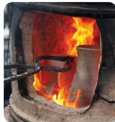
Figura 1.36 Para fabricar una vasija de cerámica se cuece la mezcla de arcilla y agua en un horno a temperaturas mayores a 300 °C.
