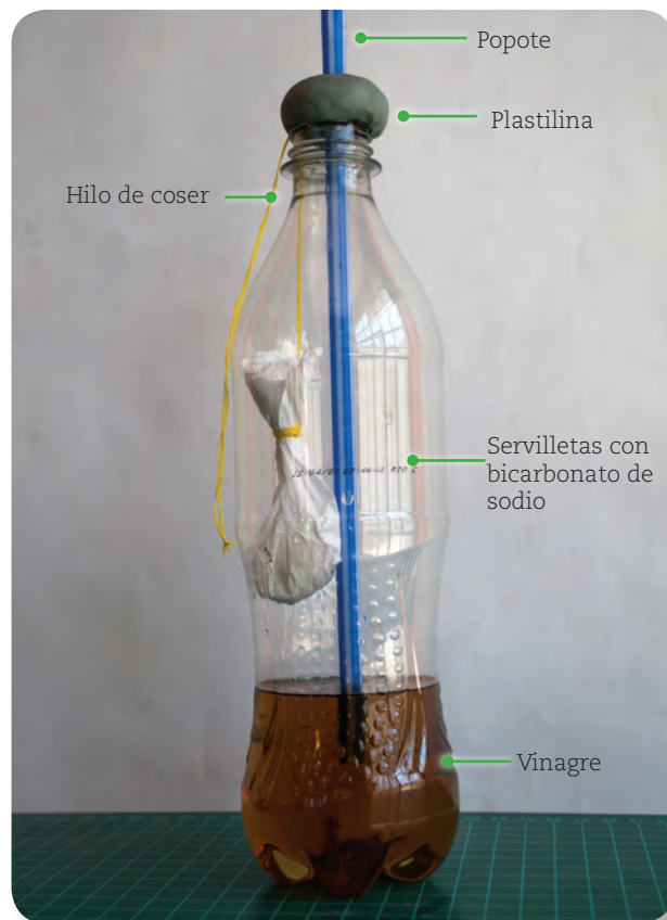
Figura 4.3 Si no cuentas con la tapa de la botella, puedes usar plastilina para sellarla.
