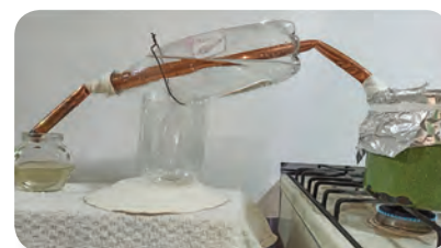
Figura 4.10 La olla debe estar completamente sellada para que el vapor se dirija al interior del tubo de cobre.
