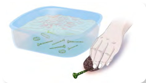
Figura 4.13 La superficie abrasiva de la fibra metálica ayuda a remover los restos de óxido.
