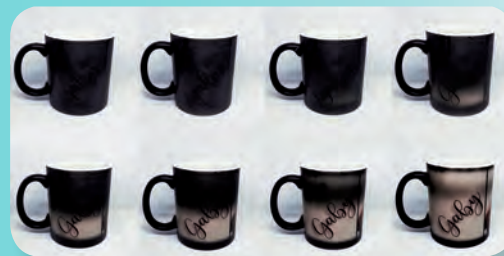
Figura 3.45 La pintura termosensible de las tazas cambia de color al ocurrir una modificación drástica en la temperatura.
