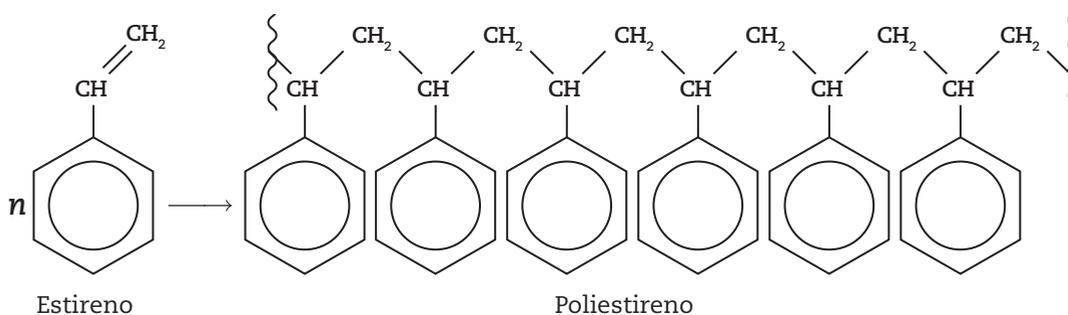
**Figura 3.31** El estireno es el monómero que se polimeriza para obtener al poliestireno, utilizado para fabricar el unicef. En la ecuación, el coeficiente estequiométrico  $n$  representa a un número de miles de moléculas.
