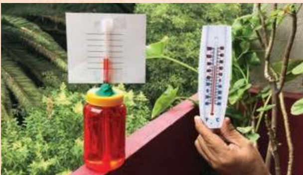
Figura 1.89 Con un termómetro casero y una regla puedes medir la temperatura de diferentes objetos.
