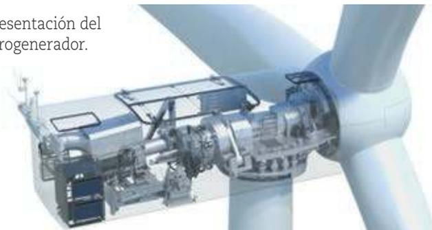
Las aspas de los aerogeneradores giran por la fuerza que ejerce el viento sobre ellas. Este giro, por medio de mecanismos, consigue que un rotor se mueva dentro de un generador y produzca energía eléctrica (figura 2.57).
