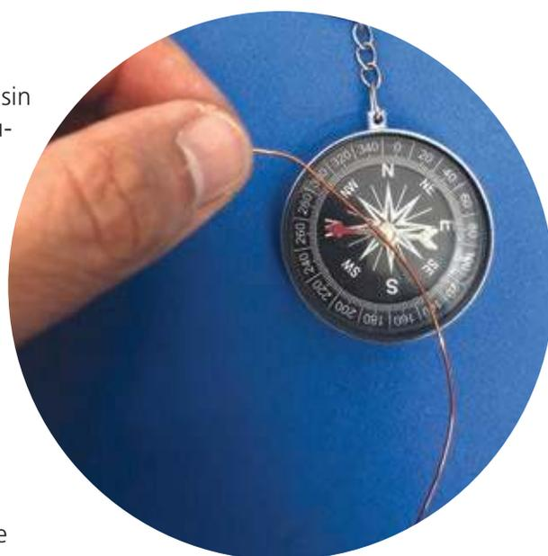
Figura 2.26 Reconstrucción del experimento realizado por Oersted.
