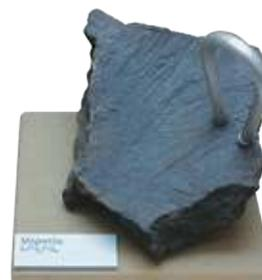
**Figura 2.16** La magnetita es un mineral con la propiedad de atraer material ferroso, es decir, con hierro.
