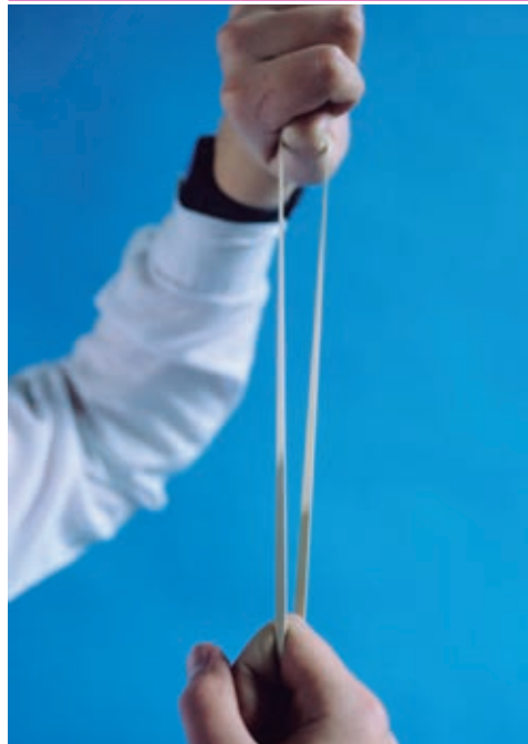
Cuando se aplica una fuerza a una banda elástica, la extensión de la banda es proporcional a la fuerza de estiramiento. Si se duplica la fuerza, la extensión de la banda será del doble.
