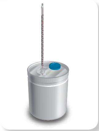
**Figura 2.31** Con este calorímetro se puede medir la energía térmica liberada en una reacción.
