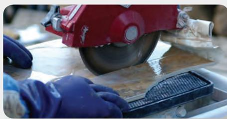
Esta sierra tiene un recubrimiento diamantado.
