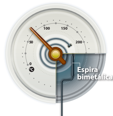
Figura 1.14 Un ejemplo de aplicación de la dilatación térmica es un termómetro de horno.
