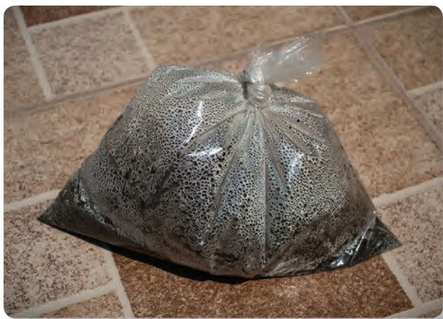
Figura 1.38 Si se deja al sol, el lodo permanece más tiempo húmedo dentro de una bolsa que fuera de ella, esto es evidente debido a las gotitas de agua que se forman dentro del plástico.
