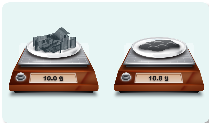
Figura 1.40 La diferencia en las lecturas de la báscula se debe a que en la combustión, el magnesio se combinó con oxígeno resultando en un producto diferente.
