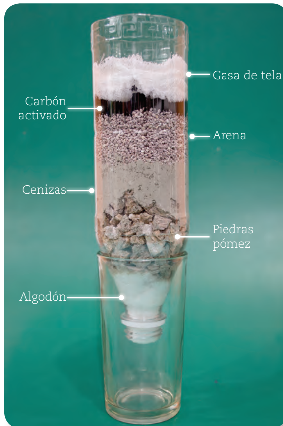
Figura 4.6 Purificador de agua casero.
