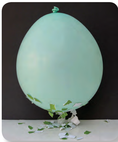
Figura 1.11 La fuerza de atracción electrostática vence a la fuerza de gravedad y los papelitos se levantan.
