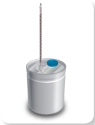
Figura 2.31 Con este calorímetro se puede medir la energía térmica liberada en una reacción.
