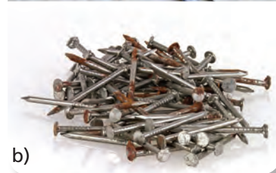
Figura 3.2 a) Los objetos de plata reaccionan con el azufre del aire cubriéndose con una capa negra de sulfuro de plata; b) los de hierro reaccionan con el oxígeno generando el óxido de hierro que le da su aspecto rojizo.
