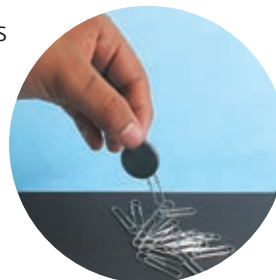
Figura 2.20 El material ferromagnético más conocido es el hierro, pero no es el único. También lo son el níquel y el cobalto.
