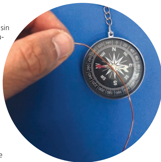
Figura 2.26 Reconstrucción del experimento realizado por Oersted.
