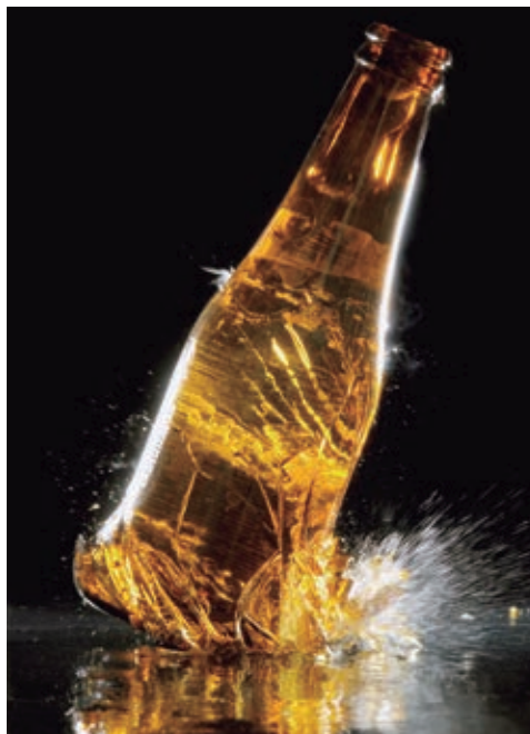
El impacto de la botella sobre la superficie dura provocó el rompimiento del vidrio en fragmentos en el punto de impacto, generando grietas que se extienden rápidamente por el resto de la botella.
