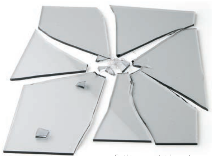
El vidrio es un material que reúne varias propiedades: es duro, impermeable, pero poco tenaz.
