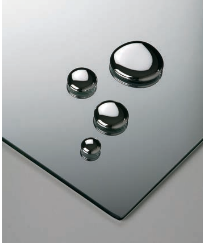
Metal en estado líquido. El mercurio se dilata y expande con el calor, por eso se usa en algunos termómetros.
