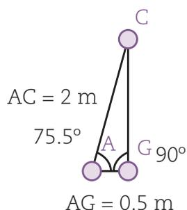
La pareja de valores correcta es 2 m y 0.5 m, lo que significa que la escalera tiene 2 m de longitud a una distancia de 0.5 m de la pared, formando un ángulo de  $75.5^\circ$ .
