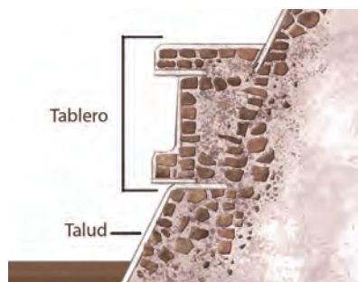
Figura 1.36 Los teotihuacanos construyeron pirámides de grandes dimensiones utilizando el talud y tablero.
