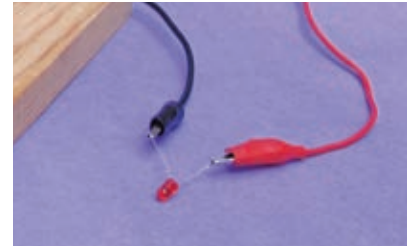
Figura 4.25 Cada extremo del led corresponde a un polo: (+) o (-).
