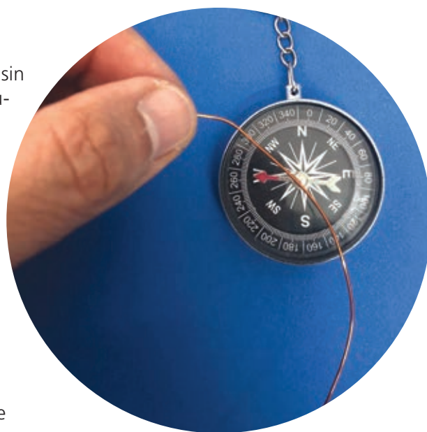
Figura 2.26 Reconstrucción del experimento realizado por Oersted.
