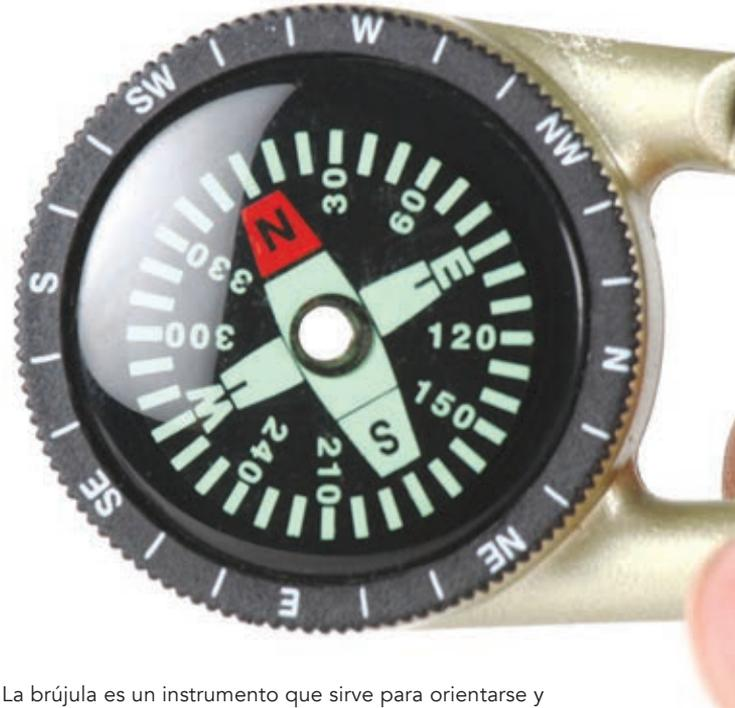
La brújula es un instrumento que sirve para orientarse y utiliza el magnetismo para su funcionamiento. La aguja siempre señala el norte magnético de la Tierra.
