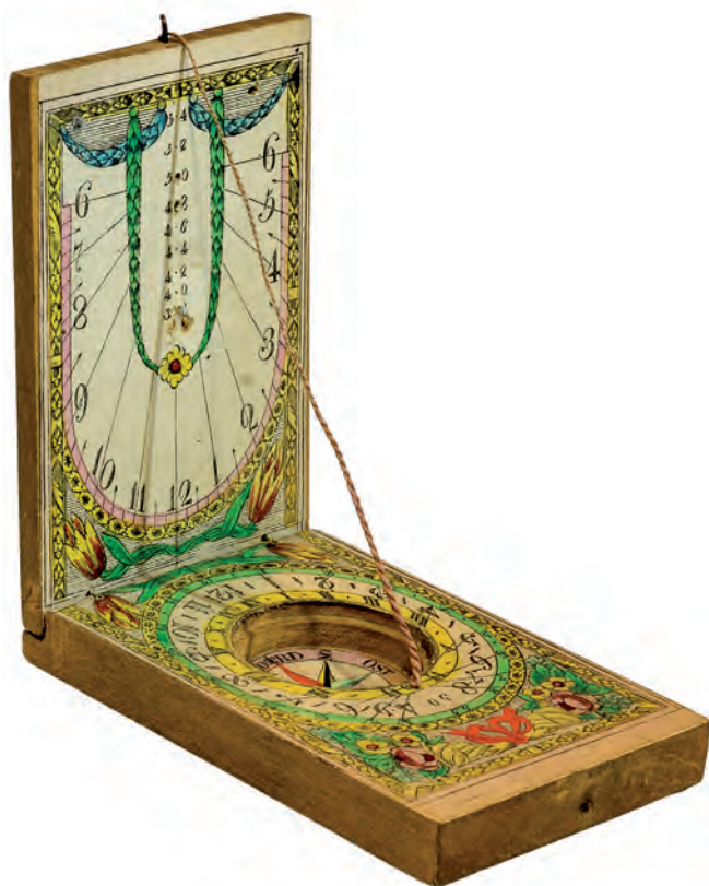
La brújula es originaria de China y los árabes la introdujeron en Europa. Es una aguja imantada que gira libremente sobre un pivote y uno de sus extremos apunta siempre al norte; permite a los navegantes orientarse sin necesidad de ver las estrellas.
