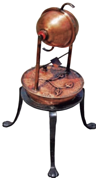
Eolípila. Dispositivo que genera movimiento con la fuerza del vapor.
