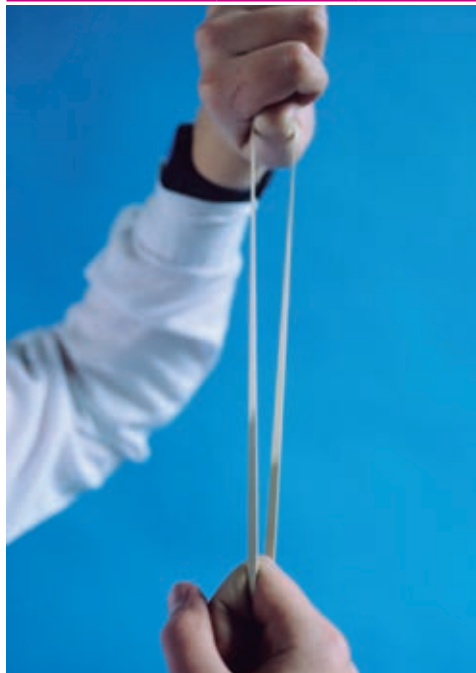
Quando se aplica una fuerza a una banda elástica, la extensión de la banda es proporcional a la fuerza de estiramiento. Si se duplica la fuerza, la extensión de la banda será del doble.
