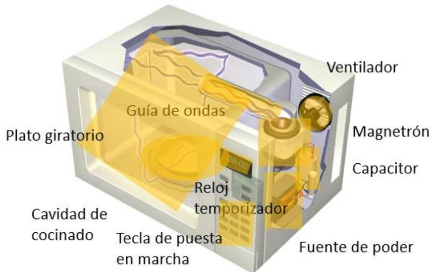
La fuente de poder se encarga de alimentar con energía eléctrica a los distintos componentes del horno.
