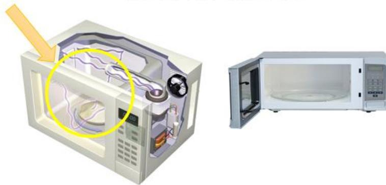
La cavidad de cocinado es el espacio que se tiene para la colocación de los alimentos. Está conformada por paredes metálicas, las cuales reflejan la radiación electromagnética para que se mantenga dentro de la cavidad. Cuando ésta penetra profundamente en los alimentos produce un incremento en su temperatura.
