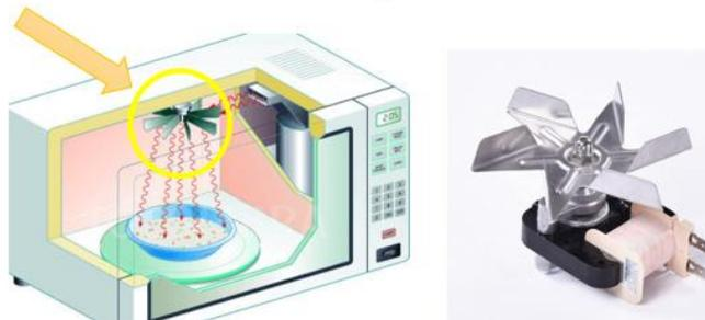
El segundo tipo de ventilador se encuentra al final de la guía de ondas, y sirve para esparcir uniformemente las ondas electromagnéticas en la cavidad de cocinado.
