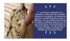
4.- La mezcla y el amasado: En el amasado, se debe tener las tres arcillas cribadas en recipiente. un mantiene en aqua por un determinado tiempo para SU dilatación. Una vez disueltas las partículas de arcillas, se obtiene la pasta que se usa para formar bolas. Este procedimiento se denomina "pitn´kuy", con este material se empieza a realizar el modelado del utensilio que se pretende formar.
