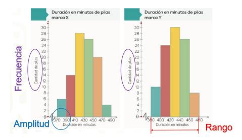
El laboratorio de una oficina de apoyo al consumidor analizó dos marcas de pilas alcalinas y midieron su durabilidad. En las gráficas se muestran los resultados. En las gráficas podemos observar que las pilas han sido identificadas como pilas de la marca "X" y pilas de la marca "Y".
