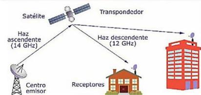
Desde que sale de la antena de la estación, la señal de televisión se propaga en todas las direcciones, como una onda, hasta que llega a la antena del televisor.
