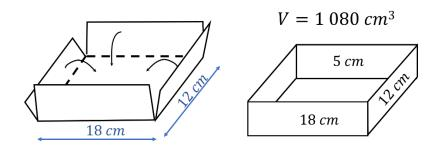
El volumen de un prisma rectangular, en este caso de la caja sin tapa, se calcula multiplicando el área de la base por su altura.
