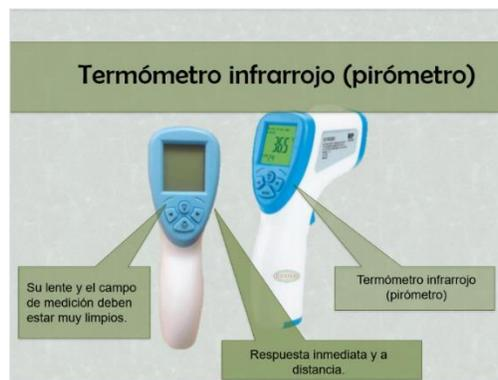
Y están también los infrarrojos, pueden medir la temperatura sin tocarnos, lo hacen gracias a que miden el calor que irradian las superficies, mediante un lente, un sensor capta la energía que recibe y después un componente electrónico traduce la señal detectada para mostrarla en pantalla.
