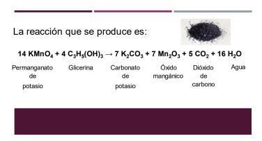
El permanganato de potasio actúa como agente oxidante provocando la oxidación del carbono de la glicerina. Esta reacción libera energía calorífica.
