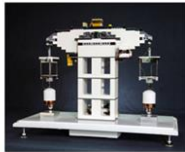
Prototipo de una balanza de watt
