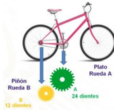
Observa el tamaño de las piezas, la rueda "A" tiene 24 dientes y la rueda "B" tiene 12 dientes, y las dos giran de manera sincronizada. Cuando el pedal da una vuelta, el plato también da una vuelta, pero el piñón, ¿da más de una vuelta o menos de una?
