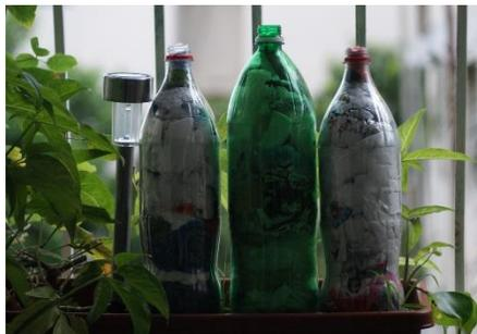
El ecoladrillo consiste en botellas plásticas de menos de 3 litros, rellenas con cualquier tipo de residuos plásticos y papel aluminio. Una vez terminado, puede servir como aislante acústico, térmico y antisísmico.
