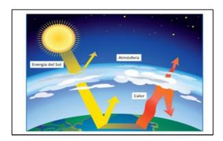
Como puedes observar, la energía del Sol llega, una pequeña parte es reflejada por la atmósfera y las nubes, pero la mayor parte llega a la superficie de la Tierra donde la energía se absorbe o se refleja en forma de calor. Parte del calor que se refleja atraviesa la atmósfera y escapa, pero gran parte se retiene por los gases de efecto invernadero de la atmósfera, produciendo el calentamiento.
