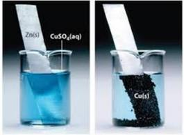
El sulfato de cobre ( $CuSO_4$ ) con zinc produce un cambio de color, esto se debe a los compuestos que se forman, los cuales son sulfato de zinc  $ZnSO_4$  y cobre metálico (Cu); con esto se verifica que se produjo un cambio en la estructura interna de los materiales.
