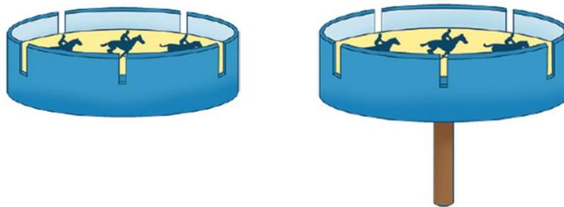
Pega las bandas sobre el círculo y coloca una tachuela en el centro del círculo, y abajo vas a ubicar la goma de un lápiz, para que el zoótropo pueda girar.
