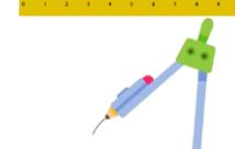
Apoya el compás en uno de los extremos de la línea que has trazado y manteniendo la abertura de 5.6 cm, vas a marcar 1 segmento de arco.
