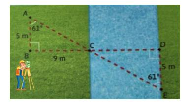
Se necesita medir el ancho de un arroyo, para ello, un topógrafo colocó postes en los puntos A, B, C, D y E. En la imagen se muestran algunas de las medidas que tomó y obtuvo las medidas que se muestran.
